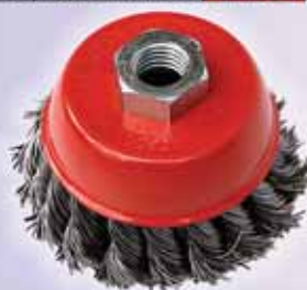
Kartáč hrnčekový vrkočový, M14x2 Fe 0,5mm, GEKO
