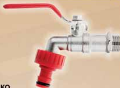
Ventil kovový pre nádrž Mauser 1000 l, závit 3/4", výstup na 1/2" hadicu, GEKO kód: G70180
